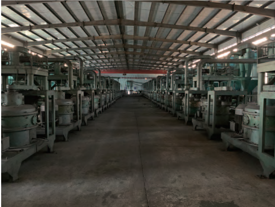
圖8-9：球形石墨加工廠的磨圓回路
